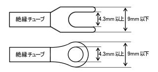
圧着端子部は、使用する 電線のサイズに合わせて ください。
