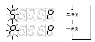
3. 選択後、「決定」キーで入力を確定します。確定すると、入力1パルス定数の設定へ進みます。
