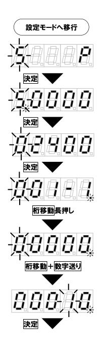
パルス幅の設定へ移行し、<設定A>パルス幅 ("40")を表示します。
