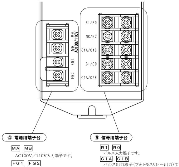
FG線接続端子です。使用時にはショート バーで接続します。
