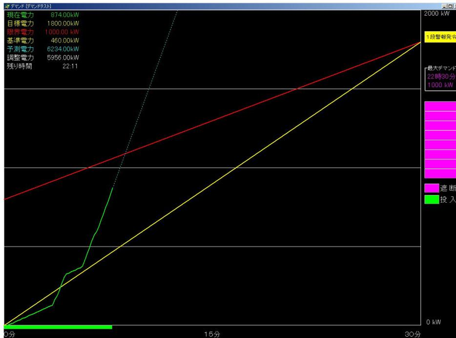
デマンド監視制御装置 (KH8,KH61:東芝(製)) からデータを取込み、電力デマンド曲線を表示 (30分周期) します。また、目標電力を超える恐れがある場合以下の警報を出力します。
