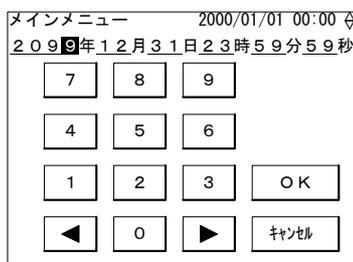
左画面のように下線がついている文字列はカーソルが移動する数字を表します。◀や▶を押すと、反転表示されているカーソルが移動します。そこで数字ボタンを押すとカーソルのある数値が入力した数値に変わります。数値を入力すると、カーソルの位置が最下桁以外は次の桁に自動的に移動します。
