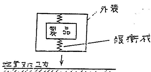
図2. 包装の一般構造図
