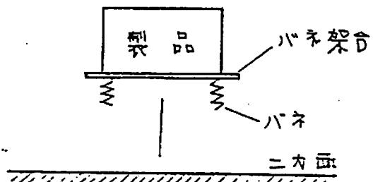
図1. バネ架台の概要
