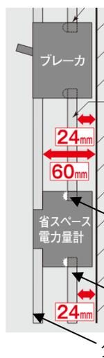
ブレーカの端子台の高さに合わせ、電力量計の端子台の高さを24mmにしているため、**ブスバーでの配線が容易です。**
