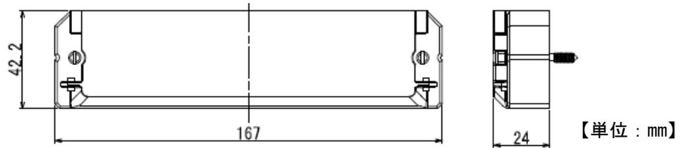
・通信端子カバー外形寸法図
