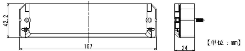
・通信端子カバー外形寸法図
